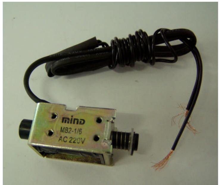
该电磁铁适用于交流电压（单相半波整流）至 220V 或直流电压 24V 的自动控制电路，广泛应用于大流量节能型水阀的自动开闭装置，具有吸力大、体积小、温升功耗低的特点。
